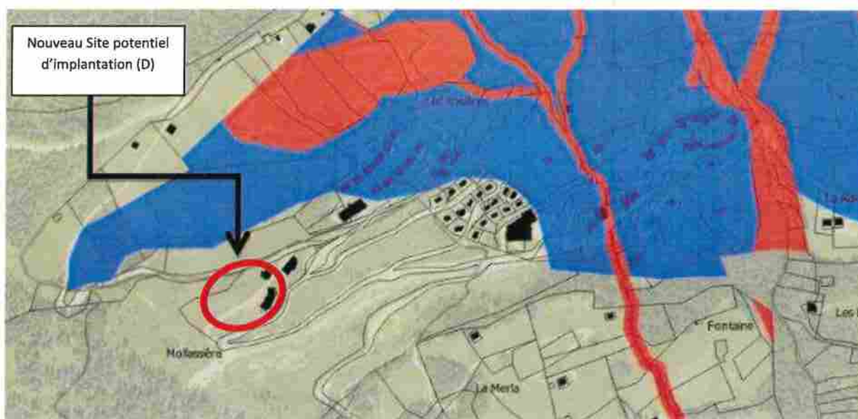
▲ Synthèse des risques naturels sur le secteur (PIZ de la commune de Villard) / rouge = inconstructible, bleu= constructible sous conditions
