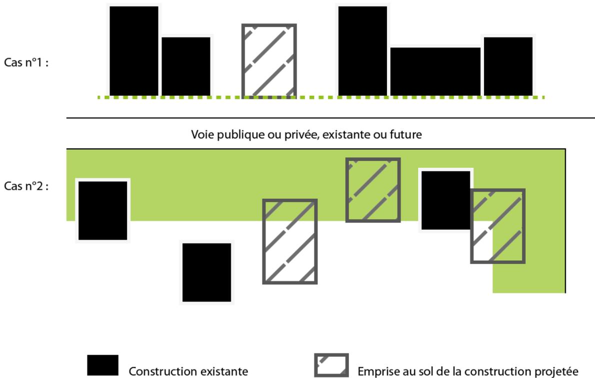
*Schéma explicatif des principes d’implantation*
